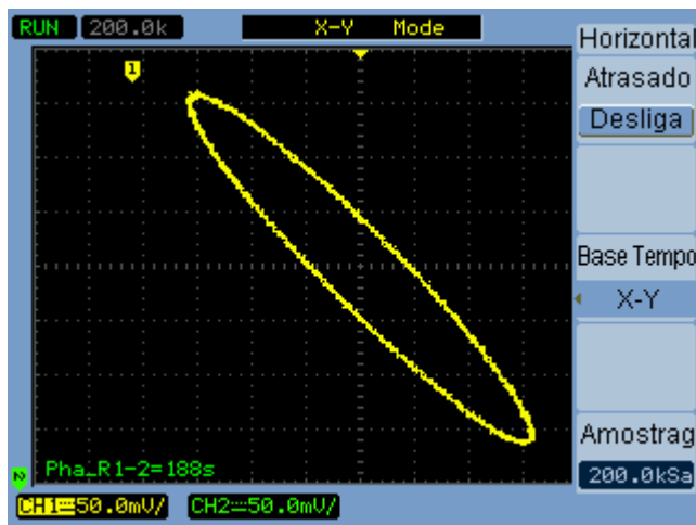
Figura 15 Formato de exibição X-Y exibindo sinais fora de fase
